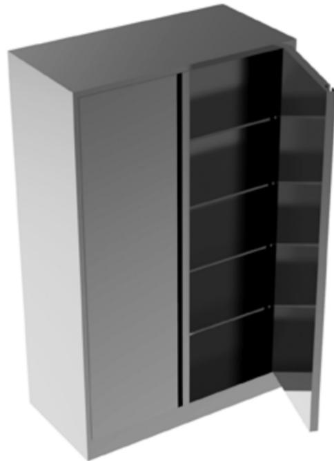
Elaborados en lámina Cold Rolled calibre 18 - 20. Cada entrepaño soporta hasta 80 kilos de peso; sistema de sujeción de la bandeja por medio de uña.
